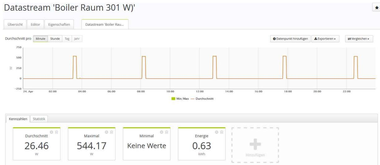
Der Kleinspeicher für die Reinigungszwecke wurde in dieser Woche nur 2 x genutzt und von den 6,04 kWh/Woche können nur 1,63 kWh als Nutzenergie angesetzt werden. Die täglichen Bereitschaftsverluste betragen 0,63 kWh bzw. 4,41 kWh/Woche. Dies ergibt eine Nutzenergie von 27 %. Die restlichen 73 % des Stromverbrauchs sind als Verluste anzusehen.
