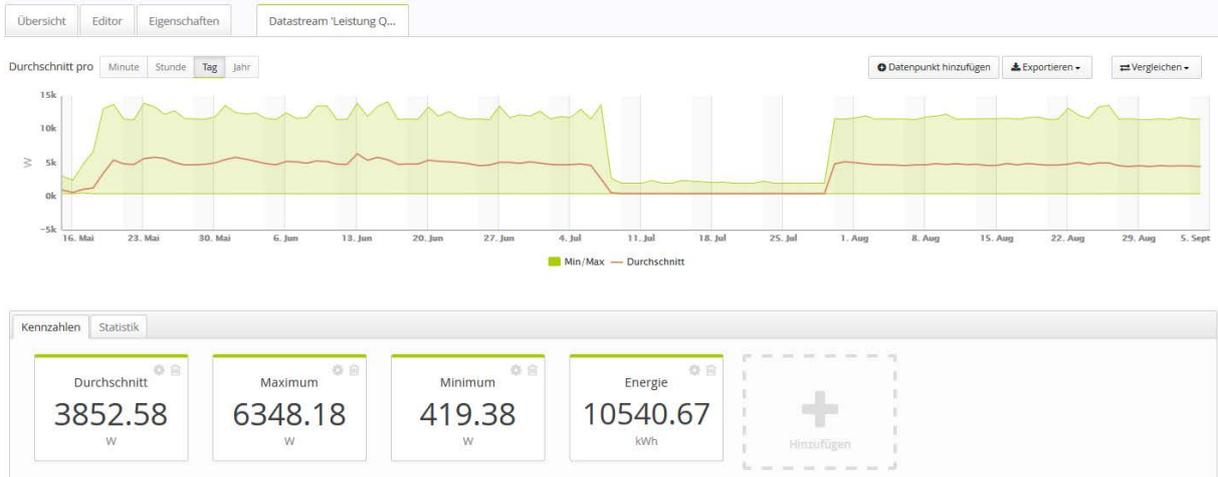
Erkennbar ist, dass der Speicher im Sommer vier Wochen außer Betrieb gesetzt wurde, was aufgrund der Hygienerichtlinie eine Spülung des gesamten Systems bedingt. Diese Spülung ist aber eigentlich auch bei durchlaufendem WW-Betrieb notwendig, weil die Zapfmengen über die Sommerferien zu gering sind. Siehe dazu auch unter Einsparmöglichkeiten.
