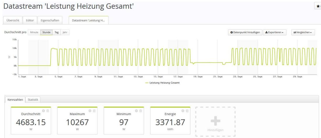
In der Zeit vom 18. bis 21. September wurde die Heizung eingeschaltet (Durchschnittsleistung 1.870 Watt). Vor der Inbetriebnahme der Heizung betrug die minimale Leistung 180 Watt. Nach dem 21. September betrug die minimale Leistung dann 540 Watt, da einzelne Pumpen bzw. Regelungen kompliziert über die Sicherung extra ausgeschaltet werden müssen.
