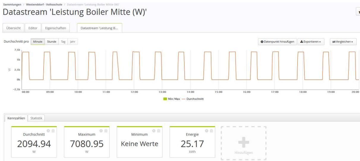
Bei einer durchlaufenden Zirkulationspumpe betragen die Speicherverluste und Zirkulationsverluste insgesamt ca. 50 kWh pro Tag. D.h. die Zirkulationsverluste erhöhen sich bei einer normgerechten Betriebsweise bzw. durchlaufender Zirkulation von ca. 30 kWh auf 42 kWh pro Tag.
