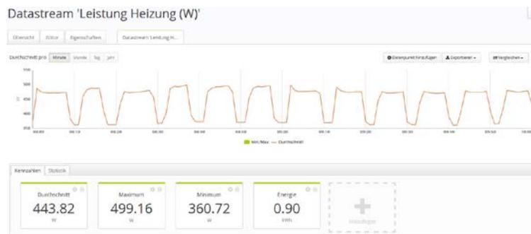
Gut zu erkennen ist das häufige Takten des Heizkessels, der seit der Sanierung des Gebäudes (Heizzentrale blieb unverändert) auch für den Winterfall deutlich zu groß ist.
