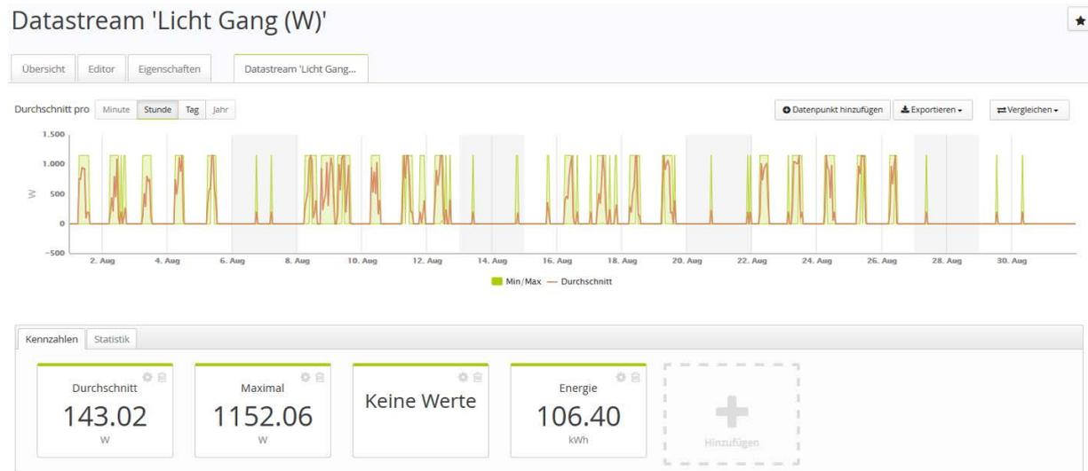
Man sieht die hohe Einschalthäufigkeit der Gangbeleuchtung in den Sommermonaten durch die Reinigungstätigkeiten im gesamten August. Zu beachten ist, dass hier nur ein Teilbereich der Gangbeleuchtung (Hälfte eines Stockes) in der Messung enthalten ist.
