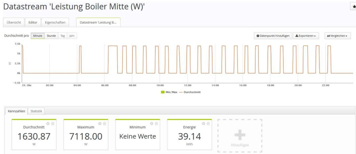
Die Verbrauchsstruktur zeigt, dass so gut wie keine Nutzung vorliegt (sichtbar erst am Abend – jedoch auch dort nur in geringem Ausmaß). Die Zirkulationsverluste (inkl. Aufheizung der Zirkulationswassermenge) betragen über 30 kWh pro Tag.
