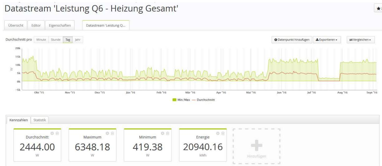
Deutlich sichtbar ist die el. WW-Bereitung ab Mitte Mai. Das hinsichtlich der Hygiene relevante Ausschalten der WW-Bereitung im August ist auch bei den Monatsverläufen erkennbar. Dieses Beispiel wird bei der WW-Bereitung nochmals ausführlich beleuchtet, da der Nutzungsgrad unter 5 % beträgt.
