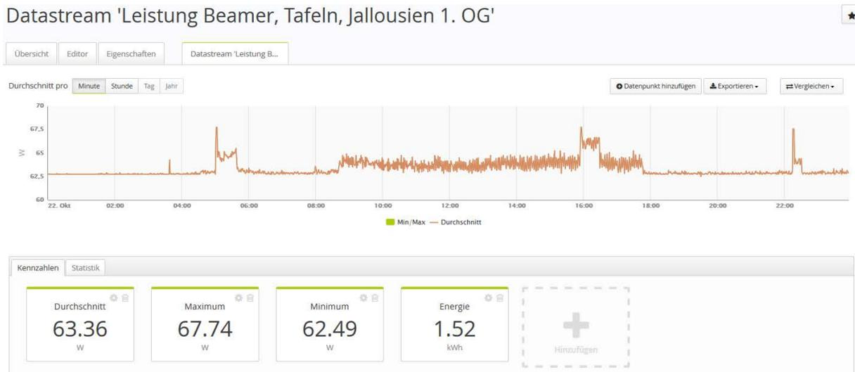
Aus dem Vergleich von Sonntag und einem Wochentag ist auch bei diesem Leistungsverlauf ersichtlich, dass nur 1,1 kWh/Tag tatsächliche Nutzung vorliegen. Der Standby beträgt ohne Korrektur des Cos Phi 1,4 kWh. Mit einem geschätzten cos Phi von 0,2 beträgt der Standby Verbrauch ca. 0,3 kWh/Tag.
