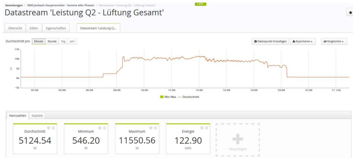
Die dargestellte Anlage, ohne variable Druckregelung, hat einen CO<sub>2</sub>-Fühler, der auf 800 ppm eingestellt ist, zudem gibt es einen Kurzschluss zwischen Fortluft und Zuluft. Beides, in Kombination mit einer sehr komfortorientierten Regelungseinstellung (800 ppm), kann als mögliche Ursache für die nur sehr langsame Leistungsabnahme nach Schulschluss angesehen werden. Der Unterschied zu einer konstant, mit Zeitschaltuhr betriebenen Anlage ist hier nur sehr gering.
