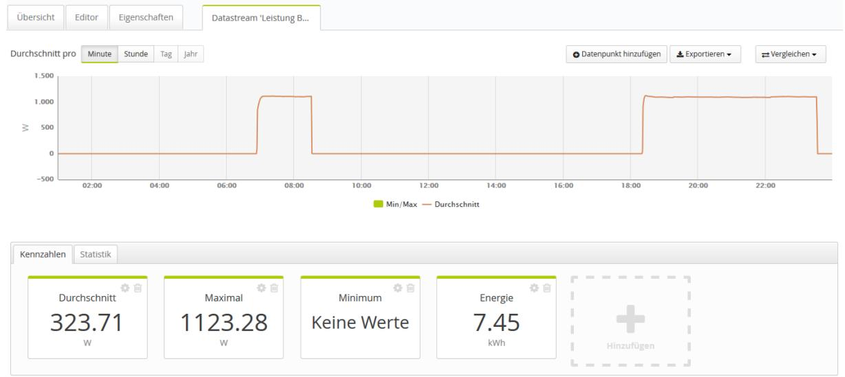
**Beispiel 2:** Durchschnittlicher Verbrauch durch Downlights mit Zeitsteuerung, die für Sommer- und Winterhalbjahr angepasst wird.
