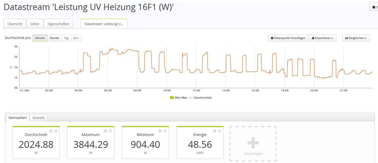
Auch hier sieht man gut den Verlauf der Grundwasserwärmepumpe (ca. 1.700 W) und die ca. 1.600 W für die restlichen Verbraucher des Heizungsbereichs. Man erkennt auch, dass, obwohl die Wärmepumpe in der Nacht eigentlich nie läuft, das sonstige Verteilsystem fast mit der gleichen Leistung von ca. 1.500 W durchläuft. Hierin liegt sicher ein wesentliches Sparpotenzial für diesen Verbrauchsbereich. Der Anteil der Grundwasserpumpe am Stromverbrauch der Wärmepumpe beträgt ca. 10 %.
