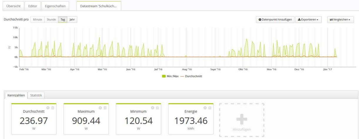
In den Werten der Schulküche ist der Stromverbrauch für die Lüftung noch nicht enthalten. Diese hat eine Gesamtleistung von 1,8 kW. Das bedeutet bei 100 Betriebsstunden nochmals ca. 1.800 kWh/a.
