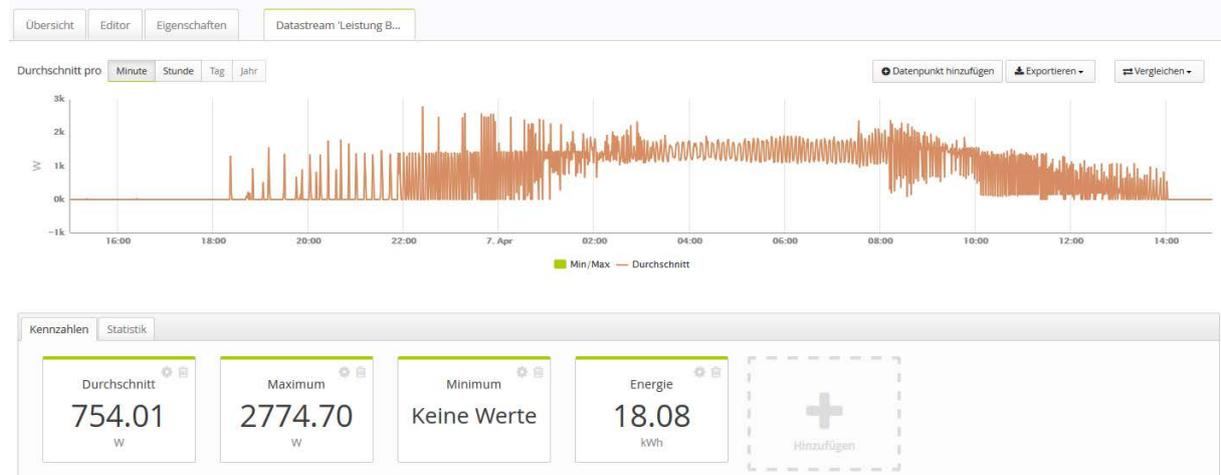
Der Brennvorgang am 7. April 2017 benötigte 74 kWh.
