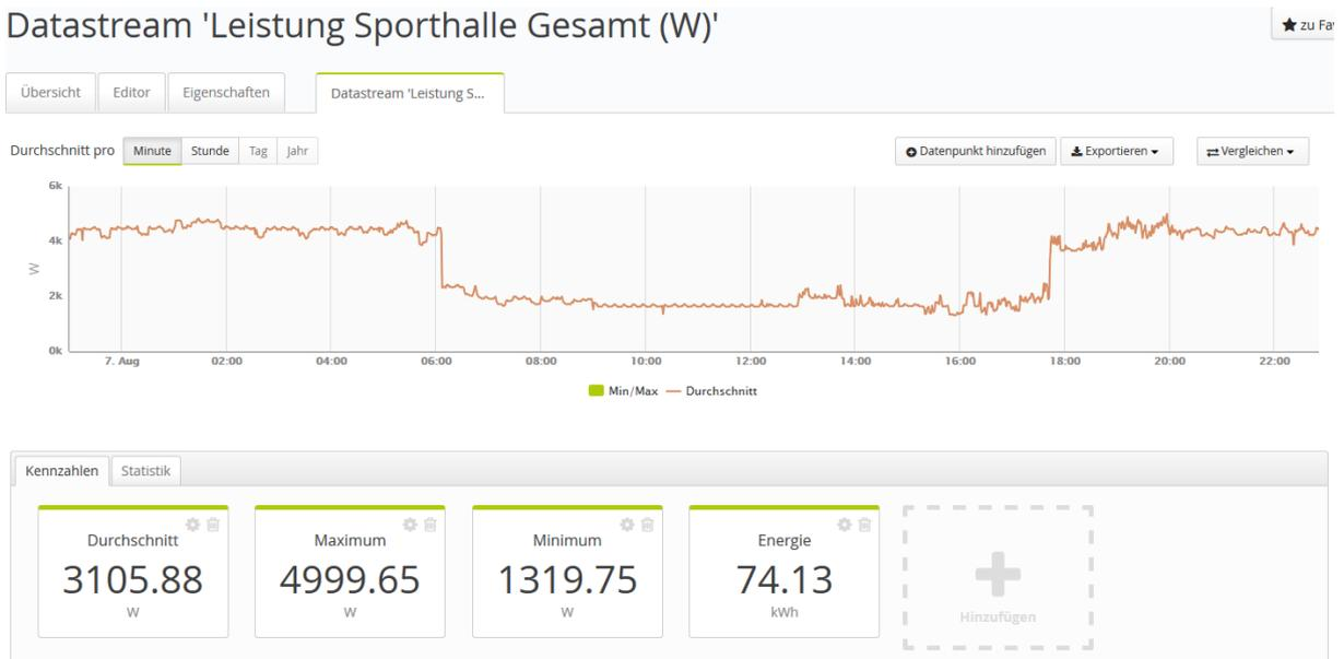
Aus den beiden Tagesverläufen ist die Außenbeleuchtung von 16:00 bis 6:00 Uhr bzw. im Sommer von 18:00 bis 6:00 Uhr ersichtlich.
