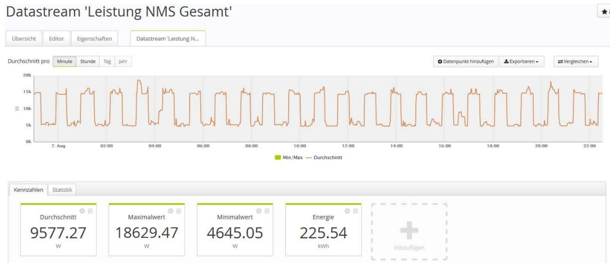
Man erkennt die laufende Warmwasserbereitung (bezüglich deren möglicher Abschaltung wird auf das Kapitel zur zentralen WW-Bereitung verwiesen.) und die Grundlast von 4.645 W.
