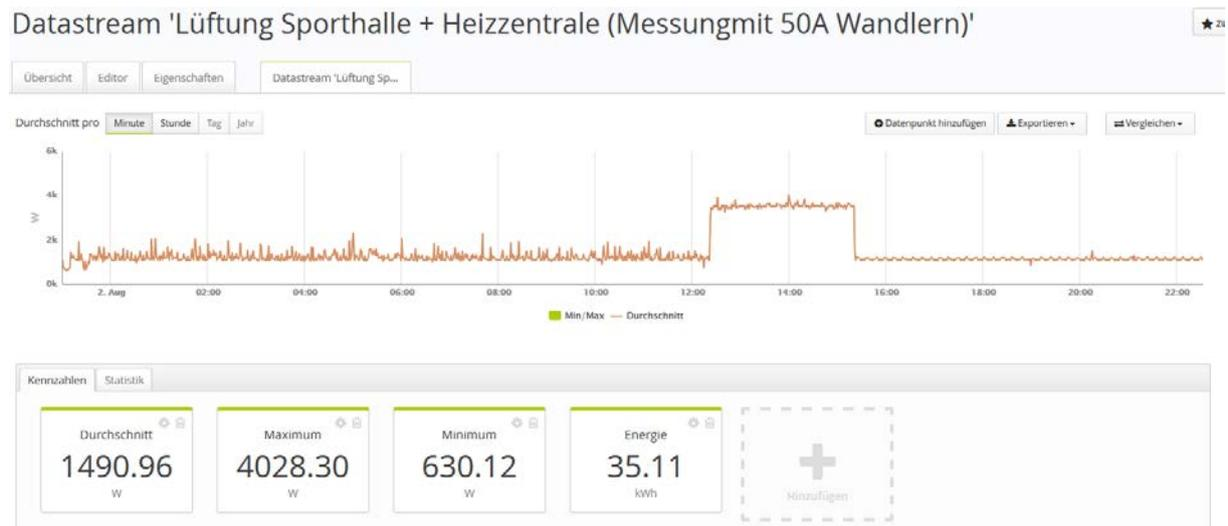
Der Betrieb zwischen 13:00 und 15:00 Uhr war nicht durch eine Nutzung bedingt, sondern ist fix programmiert. Die 750 Watt Grundlast kommen von der Lüftung bzw. der restlichen Haus-technik (WW ganzjährig mit dem Heizkessel).
