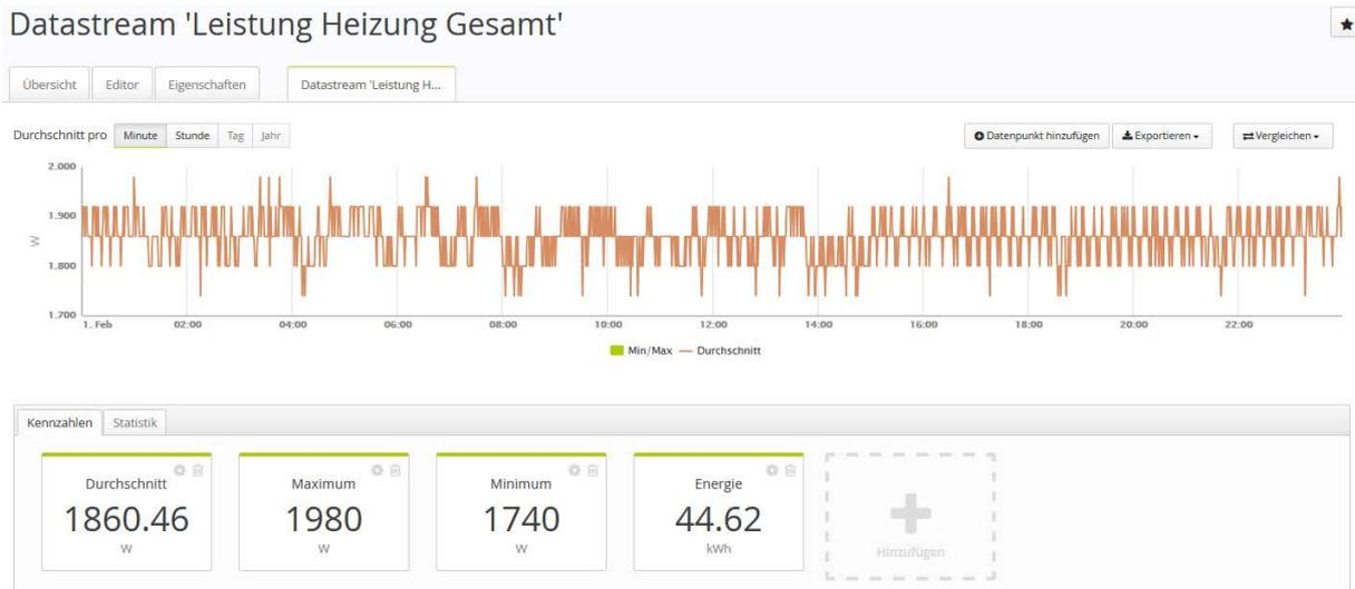
Bei einem sehr gut gedämmten Gebäude, wie es diese sanierte Schule darstellt, könnte die Wärmeversorgung in der Nacht normalerweise ohne Probleme einige Stunden komplett außer Betrieb gesetzt werden.
