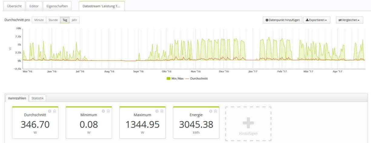
Bezogen auf die installierte Leistung für die Beleuchtung von 6 kW ergeben sich, ohne Einbeziehung der restlichen Verbraucher bzw. der Grundlast, 500 Volllaststunden. Wenn man die restlichen Verbraucher bzw. die Grundlast einrechnet, ergeben sich nicht einmal ganz 400 Std. für die Beleuchtung.
